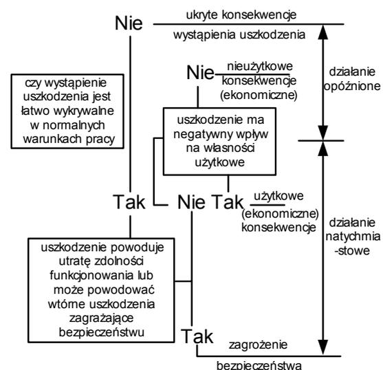
Rys. 1. Schemat niezawodnościowo zorientowanej analizy sytemu stosowanej w lotnictwie [8]
