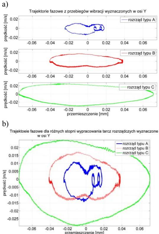
Rys. 8. Trajektorie fazowe wyznaczone z przebiegów vibracji zmierzonych w osi Y: a) przebiegi indywidualnych trajektorii, dla tarczy typu A, B, C, b) zestawienie porównawcze
