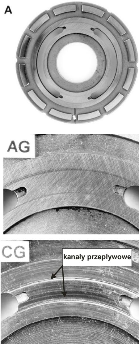
Rys. 2. Widok tarczy rozządowej wraz z strefami przejściowymi: A) ogólny widok tarczy, AG) strefa przejściowa tarczy sprawnej, CG) strefa przejściowa tarczy wypracowanej
