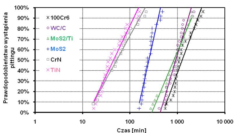
Rys. 3. Wyniki badań zmęczeniowych badanych skojarzeń materiałowych smarowanych olejem mineralnym RL 144
