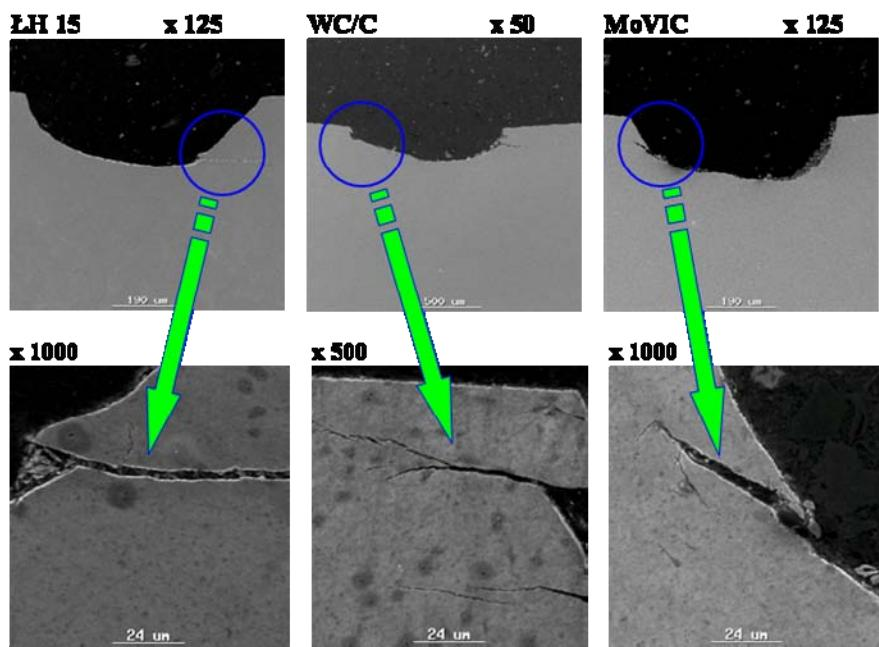
Rys. 9 Przykładowe obrazy pęknięć zmęczeniowych zidentyfikowane na elementach testowych
