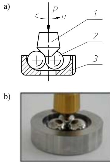
Rys. 2. Węzeł tarcia aparatu T-03 do badania zużycia zmęczeniowego materiałów stosowanych na wysokoobciążone elementy toczne: a) schemat: 1-próbka stożkowa, 2-kulki dolne, 3-bieżnia., b) widok
