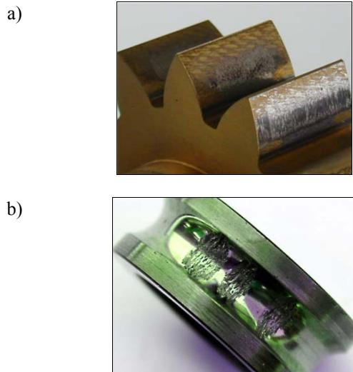
Rys. 1. Główne formy zużycia wysokoobciążonych elementów maszyn: a) ślady zatarcia na zębie koła przekładni, b) pitting na bieżni wewnętrznej lożyska kulkowego
