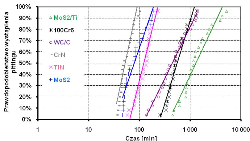
Rys. 5. Wyniki badań zmęczeniowych badanych skojarzeń materiałowych smarowanych olejem syntetycznym PAO 8
