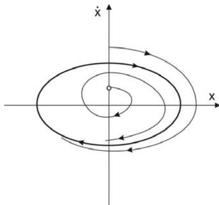
Rys. 4. Przykładowa trajektoria fazowa z cyklem granicznym
