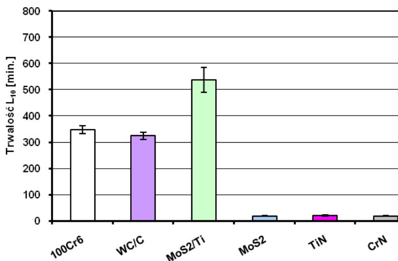
Rys. 8. Powierzchniowa trwałość zmęczeniowa  $L_{10}$  badanych skojarzeń materiałowych smarowanych olejem rzepakowym rafinowanym
