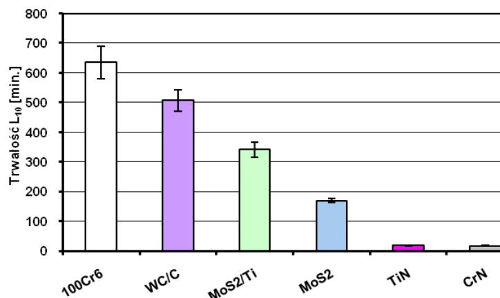
Rys. 4. Powierzchniowa trwałość zmęczeniowa  $L_{10}$  badanych skojarzeń materiałowych smarowanych olejem mineralnym RL 144
