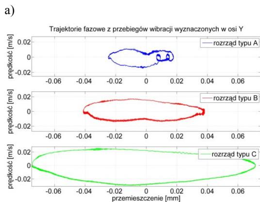
Rys. 9. Trajektorie fazowe wyznaczone z przebiegów vibracji zmierzonych w osi Z: a) przebiegi indywidualnych trajektorii, dla tarczy typu A, B, C, b) zestawienie porównawcze
