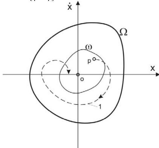
Rys. 3. Ilustracja pojęcia stateczności technicznej:
