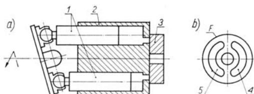
Rys. 1. Uproszczony schemat pompy wielotłoczkowej osiowej: a) przekrój poprzeczny, b) widok tarczy rozdzielczej (rozrządu pompy), 1. tłoczki, 2. wirnik, 3. tarcza rozdzielcza, 4. otwór ssawny, 5. otwór tłoczny
