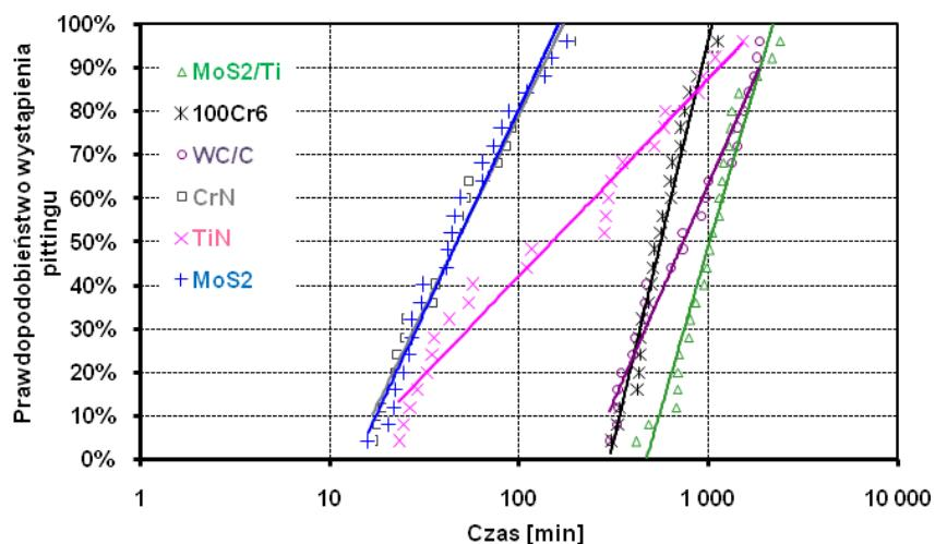
Rys. 7. Wyniki badań zmęczeniowych badanych skojarzeń materiałowych smarowanych olejem rzepakowym rafinowanym RzR
