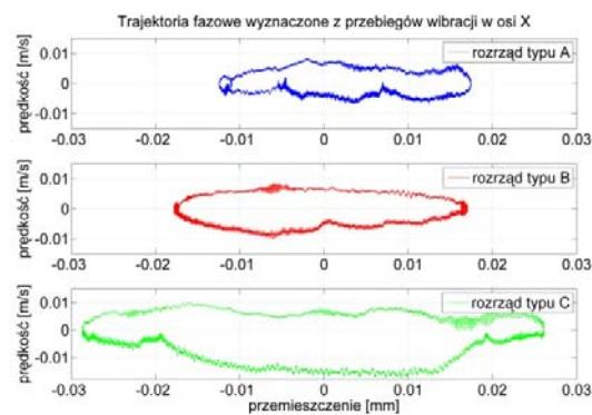
Rys. 7. Trajektorie fazowe wyznaczone z przebiegów vibracji zmierzonych w osi X: a) przebiegi indywidualnych trajektorii dla tarczy typu A, B, C, b) zestawienie porównawcze
