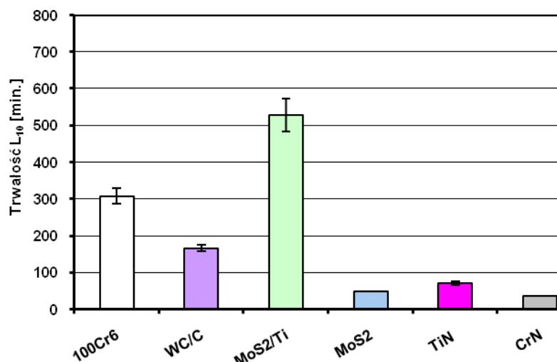
Rys. 6. Powierzchniowa trwałość zmęczeniowa L<sub>10</sub> badanych skojarzeń materiałowych smarowanych olejem syntetycznym PAO 8
