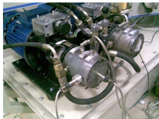
Rys. 5. Widok badanej pompy w na stanowisku badawczym
