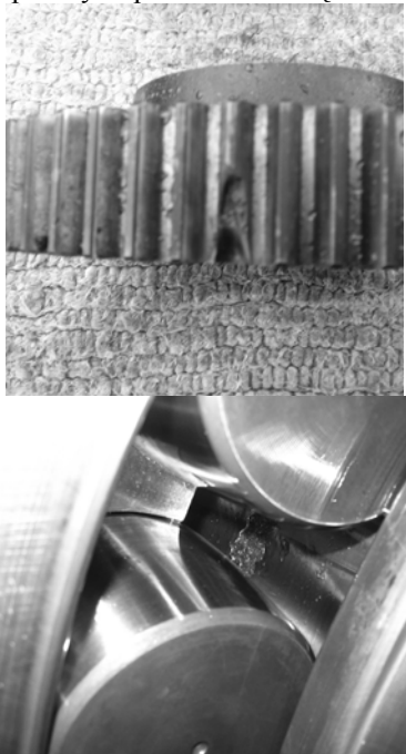
Rys. 2. Przykłady uszkodzeń lokalnych: uszkodzone koło zębate, uszkodzona bieżnia łożyska
