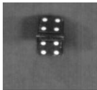
Rys. 5. Obiekt badań. Obiekt pomiarowy naklejony na wzbudnik drgań
