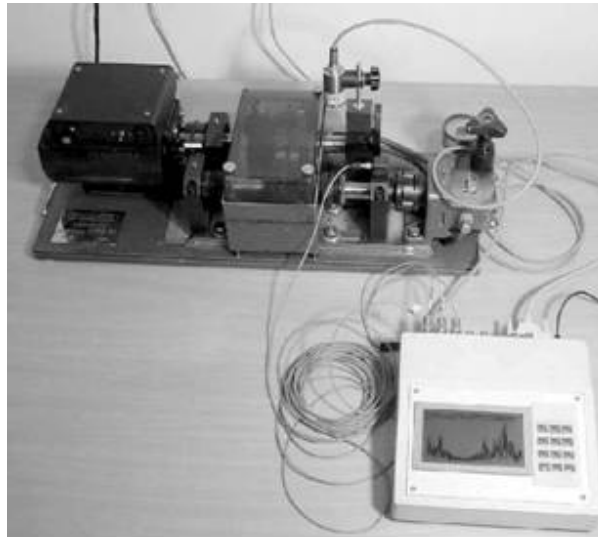
Rys. 3. Badana przekładnia laboratoryjna ze sprzętowym analizatorem PLD
