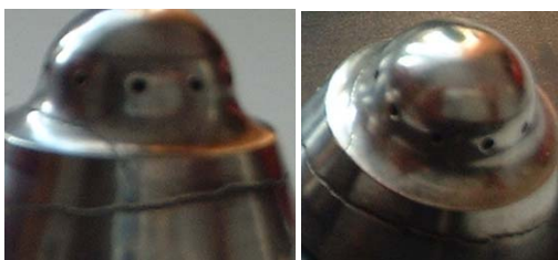
Rys. 6. Pęknięcie brodawki rozpylacza
