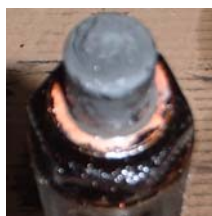
Rys. 7. Zakokszowany rozpylacz na skutek utraty szczelności układu gniazdo – stożek iglicy rozpylacza
