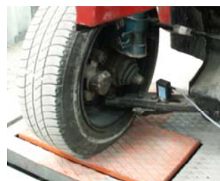
Rys. 14. Sposób mocowania przetwornika pomiarowego na wahaczu
