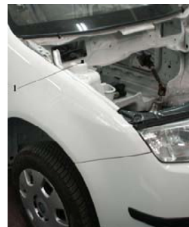
Rys. 13. Sposób mocowania przetwornika pomiarowego na nadwoziu
