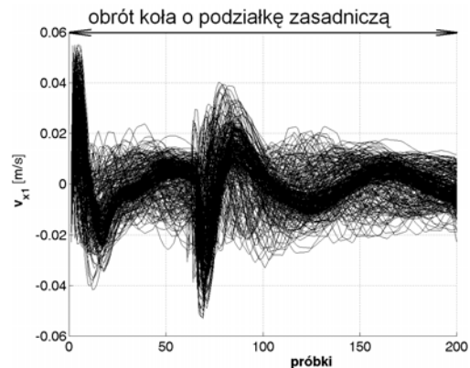
Rys. 4. Nałożenie sygnałów prędkości drgań poprzecznych wału zębniaka, których czas trwania równy jest obrotowi diagnozowanego koła zębatego o podziałkę zasadniczą – rozpędzanie i sinusoidalnie zmienny moment obciążenia
