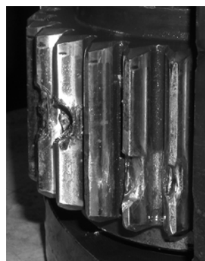
Rys. 1. Widok zniszczonego koła zębatego w efekcie wystąpienia uszkodzenia lokalnego
