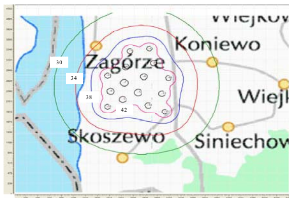
Rys. 7. Izolinie poziomów hałasu wokół farmy wiatrowej Zagórze podczas pracy wszystkich turbin
