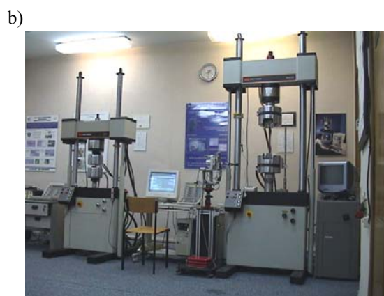
Rys. 2. Schemat stanowiska do badań weryfikacyjnych (a). Maszyny do badań zmęczeniowych Instron 8501 i 8502 (b)
