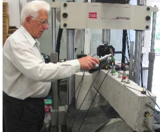
Rys.2. Testowanie belki z betonu sprężonego prowadzono po każdym kroku zwiększenia obciążenia statycznego i stopniowo postępującej degradacji struktury (pęknięcia).
