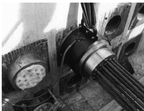
Rys.12. Czujnik siły zamocowany na obiekcie podczas weryfikacji
