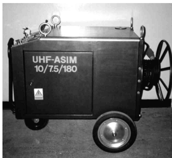
Rys. 3. Widok agregatu napędowo-sterującego UHF-ASIM 10/7,5/180
