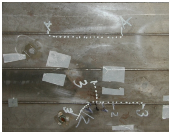
Rys. 9. Pęknięcia zmęczeniowe na modelu
