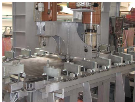
Rys. 8. Model w trakcie badań zmęczeniowych
