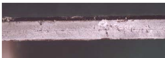
Rys. 11. Powierzchnia pęknięcia zmęczeniowego
