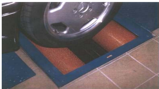
Rys. 2. Pojazd na urządzeniu rolkowym IW2 EUROSISTEM firmy MAHA.
