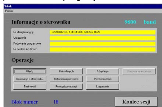
Rys. 8. Okno odczytu podstawowych informacji o sterowniku silnika
