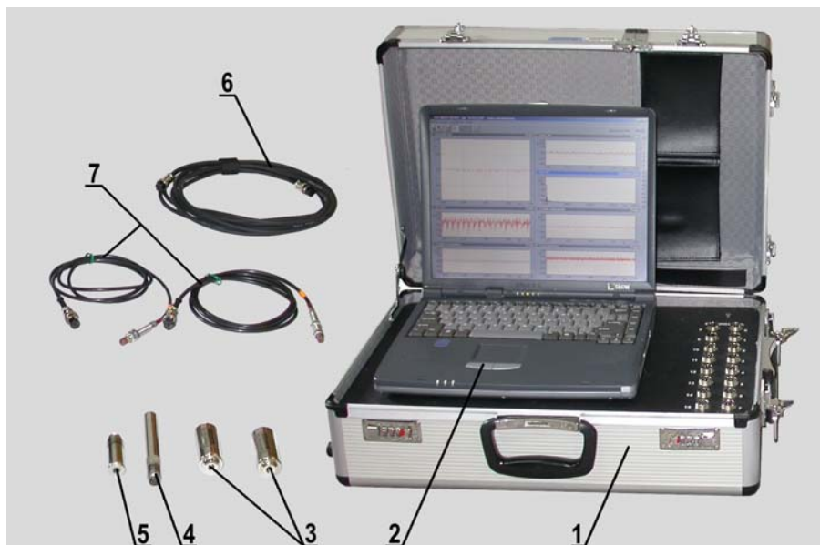
Rys. 2. Komputerowy analizator diagnostyczny KSD-400 1 – walizka z kartami przetwornikowymi, 2 – notebook, 3 – czujniki indukcyjne drgań, 4 – czujnik "foto", 5 – czujnik piezoelektryczny, 6 – przewody, 7 – czujniki wiropędowe z przewodami
