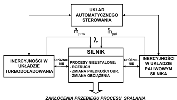
Rys. 2.1. Opóźnienia w układzie zasilania silnika
