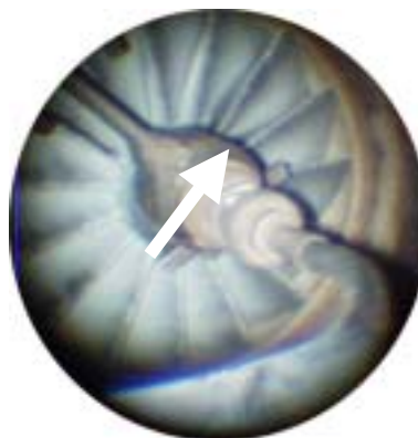
Rys. 6.5. Pomiar prędkości obrotowej wirnika turbosprężarki
