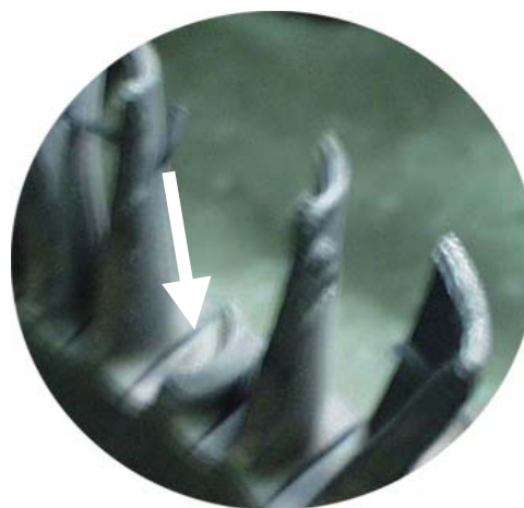
Rys. 3.2. Pęknięcie zmęczeniowe łopatek wirnikowej turbosprężarki
