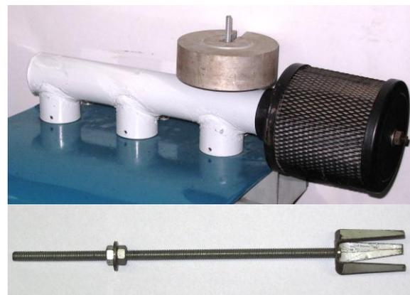
Fig. 4. Cylinder unloader
