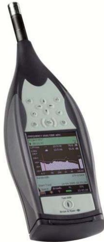
Fig. 3. Sound-level analyser type 2250
