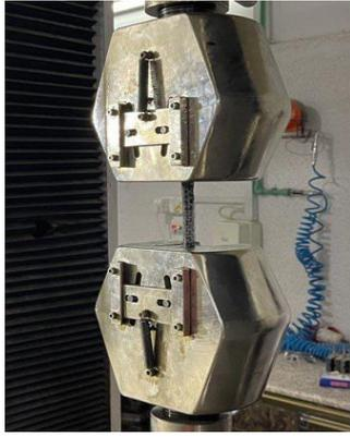
Fig. 2. Tensile test machine
