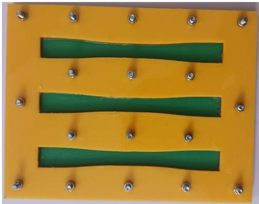
Fig. 3. Tensile Specimens mold
